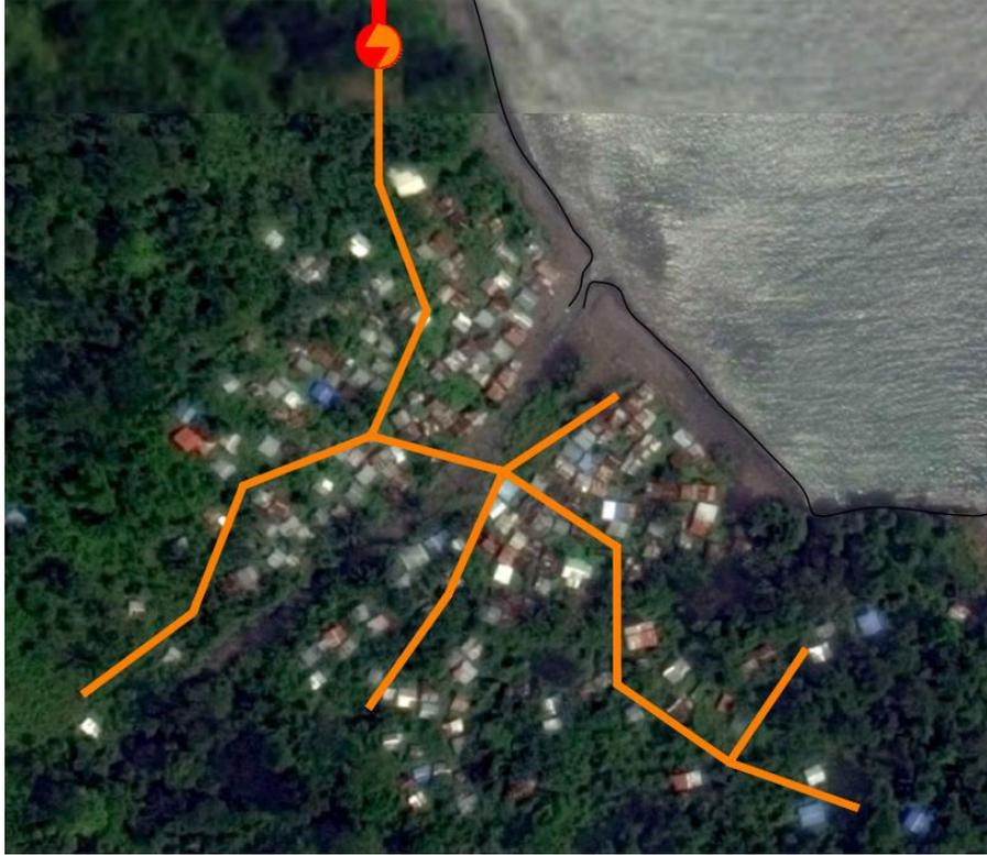
Ilustración 52: Plano de líneas de distribución de baja tensión en Aangandji (San Pedro)
